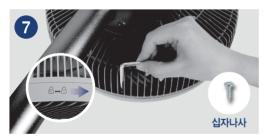
전면 안전망의 윗부분을 잠금 표시 부분으로 돌려고정시킨 후 안전망 아래의 구멍에 십자나사를 넣어전용 드라이버를 이용하여 고정시켜주세요.
